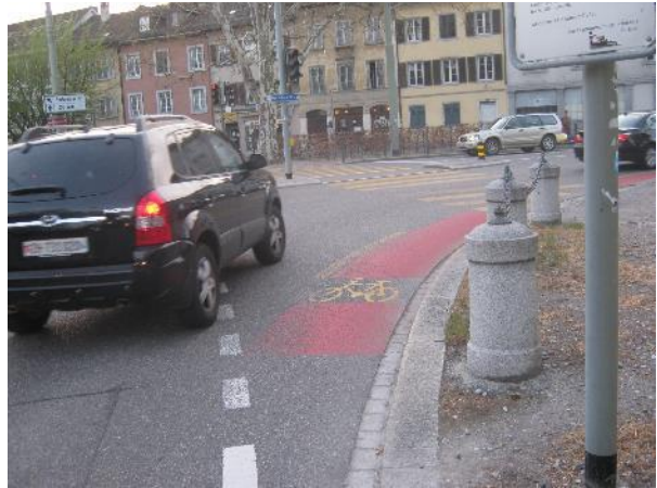
Rys. 0.11 Pasy rowerowe wzdłuż jezdni bez dodatkowych separatorów
